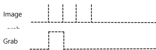
<이미지> 42. One shot trigger using bracket mode
